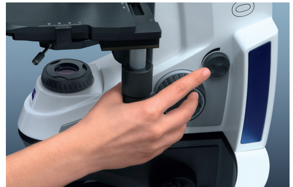
Bedienkomfort: Arbeiten mit aufgestütztem Arm; alle Hauptbedienelemente sind mit einer Hand erreichbar.
