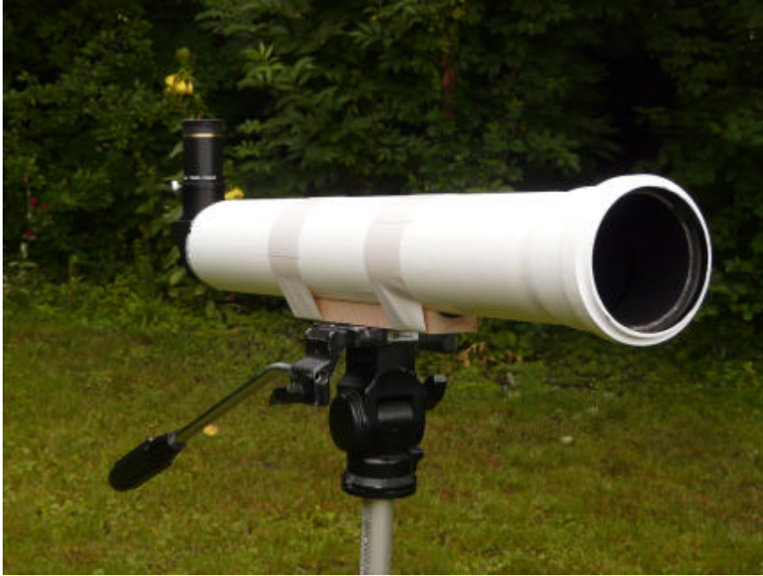
das 72/600 Selbstbau- Fernrohr auf Astromedia-Fotostativadapter
