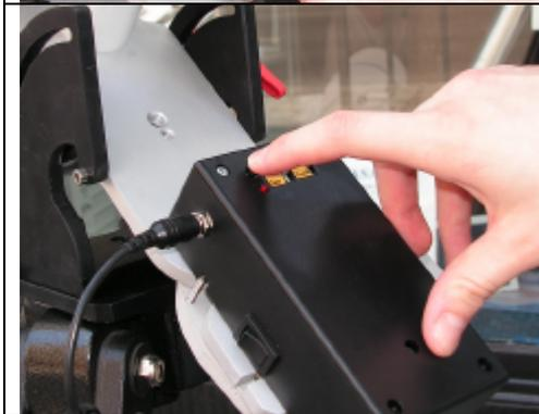
Wenn nach 2 Stunden und 15 Minuten die maximale Nachführzeit endet, wird mit dem schwarzem Kopf der Radialarm „zurückgespult“. Als Zeichen fürs Ende blinkt die rote LED.
