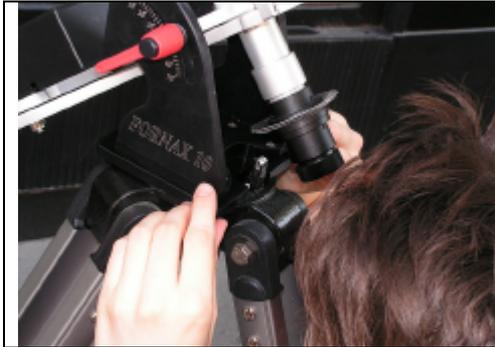
Dann den Azimut mit den beiden Klemmschrauben am Norddorn ausrichten.
