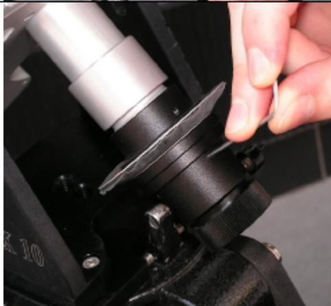
Hier sehen Sie die Zentrierschrauben nochmal genauer. Mit ihnen wird die Strichplatte verschoben, bis eine Drehung des Fornax-Armes kein Abweichen des zentralen Kreuzchens von seiner Position (zB der Kirchturmspitze) ergibt. Die Madenschrauben immer nur ein wenig drehen, sonst fällt die Strichplatte aus ihrer Fassung.
