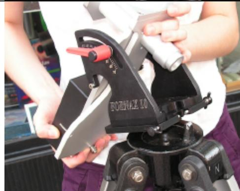
Erst befestigen Sie die Fornax-10 an einem Tripod.
