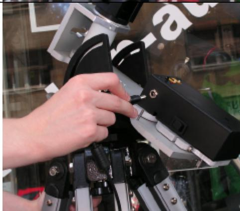
Die Stromversorgung: 12V, Stecker 5,5/2,1mm, Mitte positiv. Bei Autobatterien auf Überspannung achten. Ein Batteriebetrieb mit optionalem Pack ist ebenfalls möglich.
