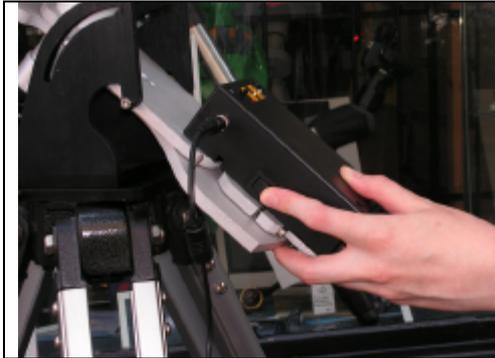
Mit dem Kippschalter wird eingeschaltet, und ein kurzer Druck auf den schwarzen Knopf neben den Dip-Schaltern startet die Nachführung.
