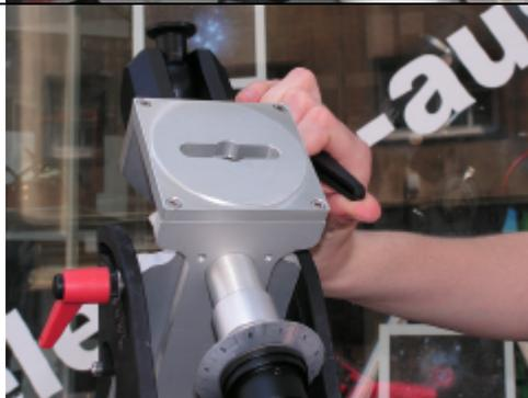
Weitere Fotoapparate und Teleskope kann man an dem Rücken der Fornax-10 befestigen. (z.B. ein Querbalkon in U-Form mit 3 Befestigungseinheiten ist als Zubehör erhältlich, auch Gegengewichte können so befestigt werden)
