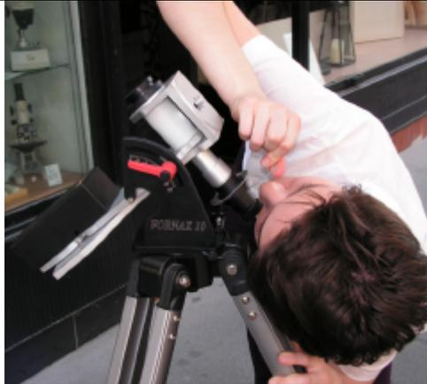
Mit drei Madenschrauben zentrieren Sie das Polarscope (z.B. an Kirchturm o.ä.), parallel zur Stundenachse der Fornax-10.
