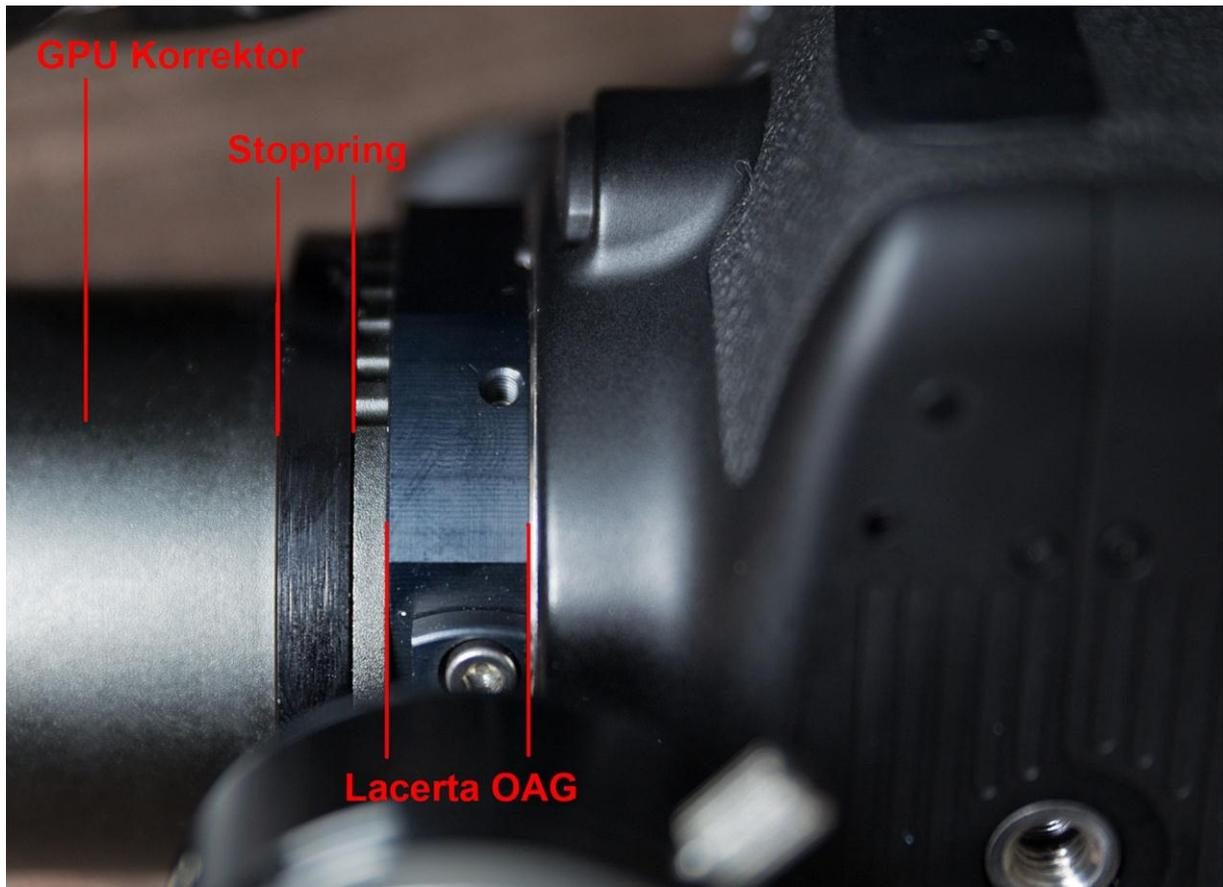
Da der GSO Newton den Fokus sehr weit draussen hat, wird ein 6mm breiter Parfokalring aufgezogen, damit der etwas herausgezogene Korrektor eine flache Auflagefläche bekommt.
