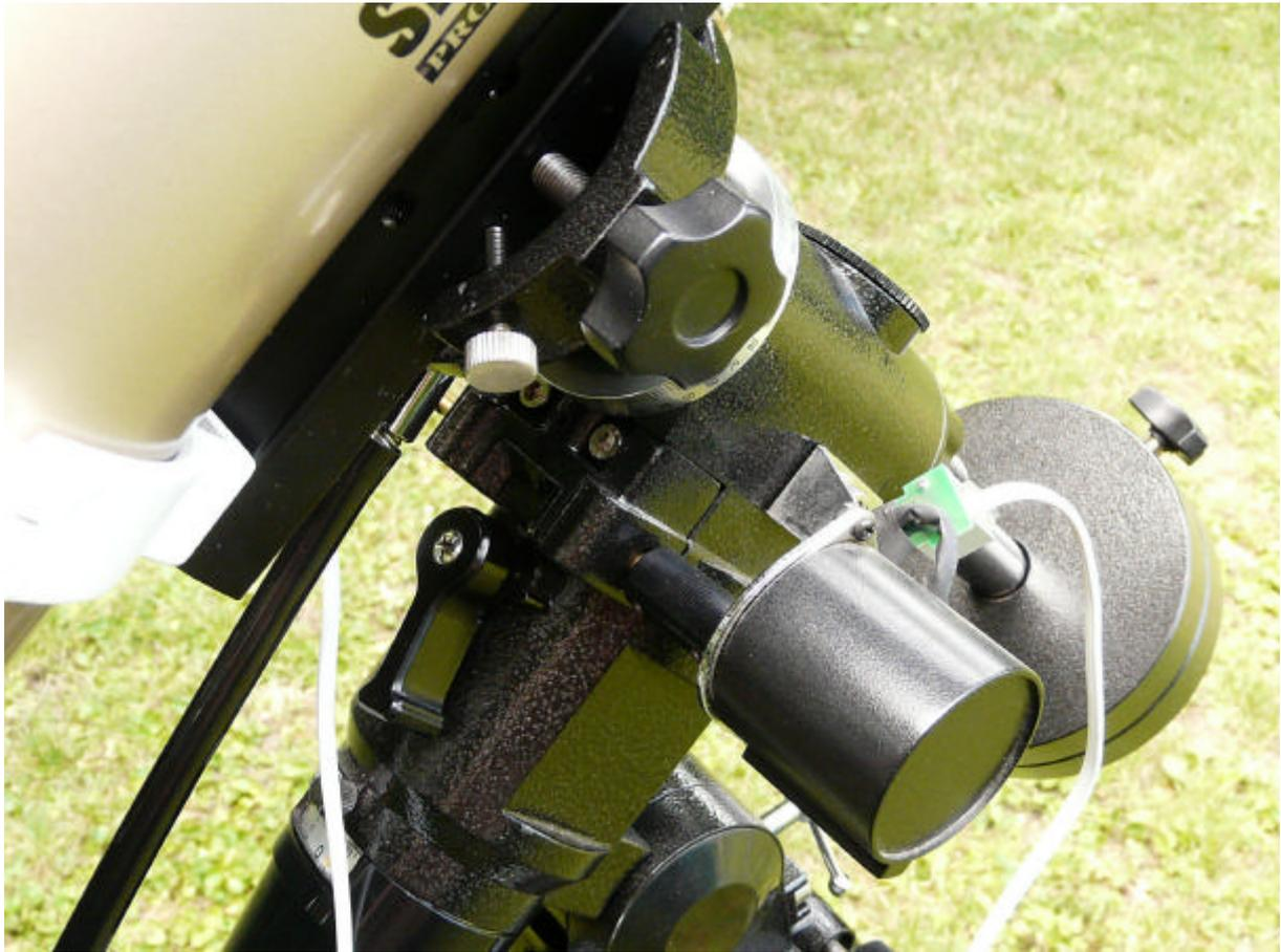
Der DEC Motor treibt über ein Zahnrad die DEC Schnecke an, und eine Kupplung ermöglicht auch das manuelle Drehen der DEC Achse:
