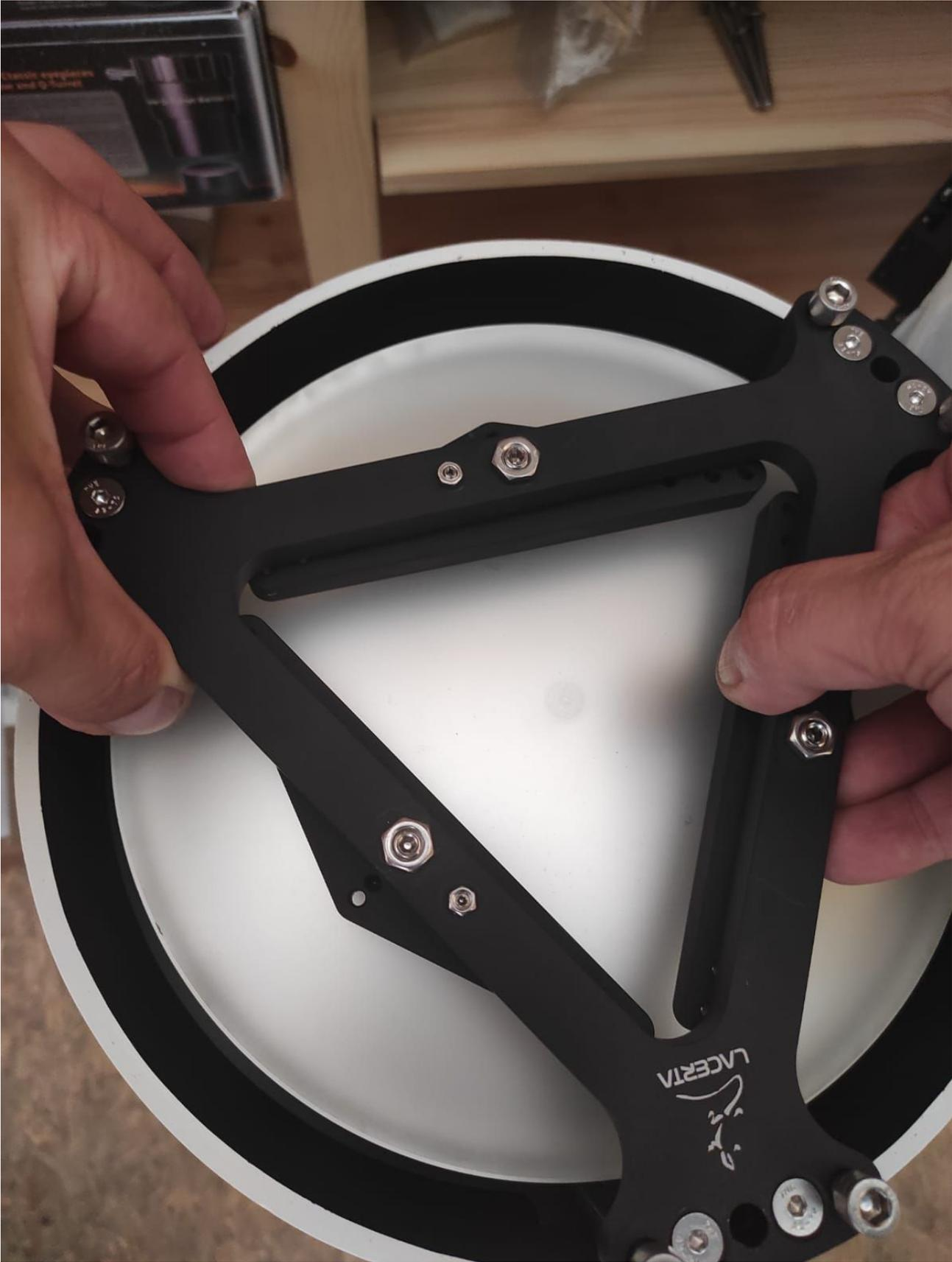
Hat man die Hauptspiegelzelle mit dem Spiegel herausgenommen, sieht man den Haltering im Tubus und die Gewinde für die Zugschrauben. Dort muss man später wieder Einschrauben:
