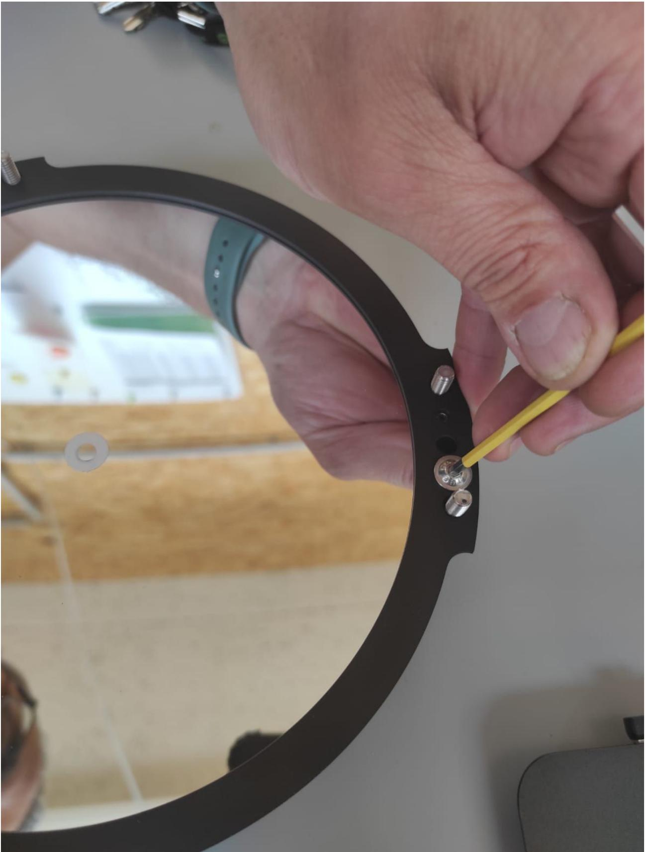
Der Hauptspiegel liegt nun frei in der Zelle, auf den 3 Wippen gelagert. Er ist gegen seitliches Verrutschen mit 3 Madenschrauben gesichert, welche in der Zelle mit Velour abgedeckt sind. Es genügt in der Regel, eine der 3 Schrauben eine halbe Umdrehung aufzumachen. Aber schauen Sie auch das nächste Bild an, bevor Sie das tun.
