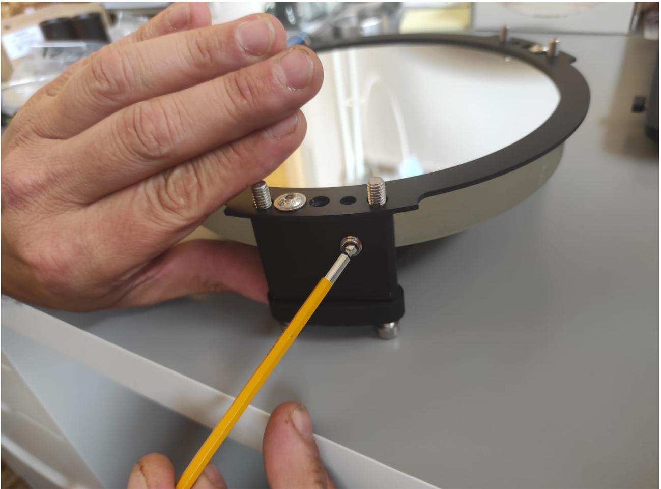
Diese Madenschrauben sind nämlich ihrerseits auch gegen Verdrehen gesichert, durch eine weitere Madenschraube die von oben gegen die laterale Sicherungsschraube drückt. Die muss zuerst aufgemacht werden:
