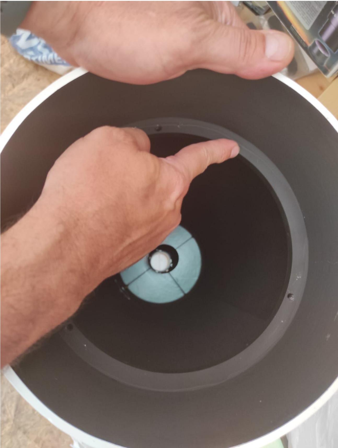
Der Blendenring ist durch 3 Inbusschrauben mit tellerförmigem Kopf befestigt. Diese Schrauben müssen herausgenommen werden, dann lässt sich der Ring entfernen um den Spiegel freizulegen:
