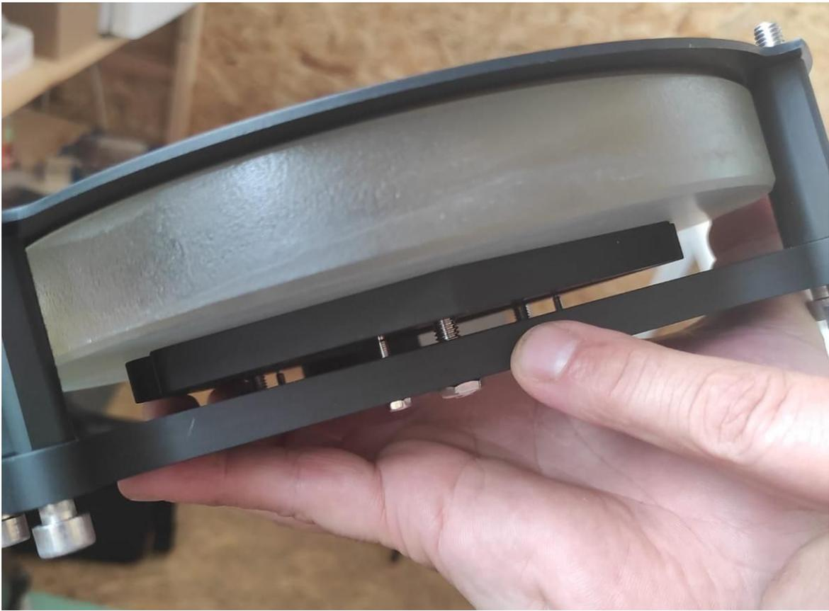
Die Stellschraube ist als Inbus Madenschraube ausgeführt, und wird durch eine Kontermutter in Ihrer Drehposition gesichert. Die Kontermutter muss gut angezogen werden, damit sich nichts von selbst verstellen kann. Die Wippen sind auf gleicher Höhe (Hauptspiegel parallel), wenn die Madenschrauben gleich weit in der Kontermutter sitzen:
