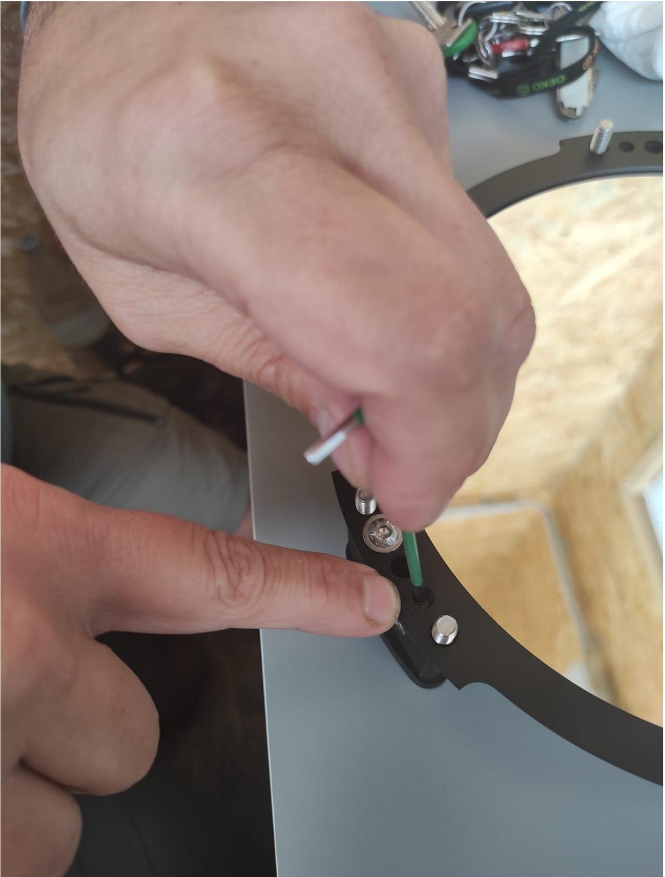
Nun können Sie den Spiegel herausnehmen und reinigen, sollte es nötig werden. Markieren Sie vorher die Rotationsposition des Spiegels, damit Sie ihn später wieder genau so einbauen können. Der Einbau erfolgt ganz einfach in umgekehrter Reihenfolge.
