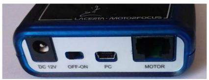
12V DC socket(5,5/2,1mm center positive) \_ Off-On switch \_ USB-B mini \_ RJ45
