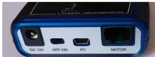
12V DC socket(5,5/2,1mm center positive) \_ Off-On switch \_ USB-B mini \_ RJ45
