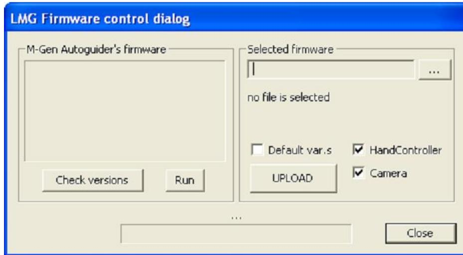
Auf der linken Seite ist Platz für Info über die Firmware des MGEN, auf der rechten kann eine am PC gespeicherte Firmware ausgewählt und zum MGEN hochgeladen werden. Einzelheiten folgen.
