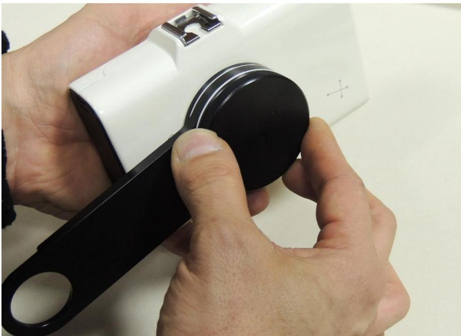
**Schritt 3: Schieben Sie den Polarscope in die Halterung und befestigen Sie ihn mit dem Konterring.**
