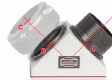
Der benötigte Backfokus lässt sich von 112 mm mit ClickLock (A-C) auf etwa 71,5 mm ohne ClickLock reduzieren (A-B).
