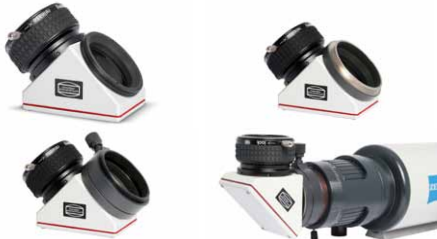
Adaption des M68-Zenitspiegels. Oben links: Das freilegende M68-Gewinde. Oben rechts: Mit M68/S68 Zeiss Wechselring. Unten links: Zusätzlich mit S68/M68-Zeiss-Wechsler. Unten rechts: Montiert am Teleskop. Mit dem Ring #2458234 kann auch die okularseitige ClickLock durch einen M68-Schnellwechsler ersetzt werden.
