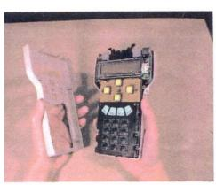
3. Entfernen Sie die vier auf der Abbildung markierten Schrauben. Die oberen Beiden sind kürzer als die beiden Unteren!
